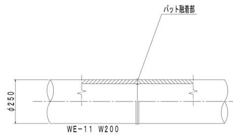
端末継手部詳細図 S=1:10
