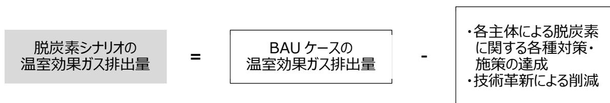
図 5.7 脱炭素シナリオの温室効果ガス排出量の推計方法
