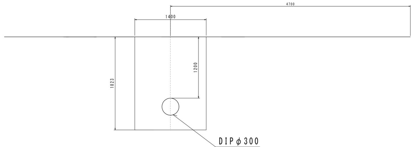
掘削標準断面図 S=1:20
