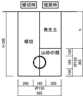
埋設断面図(未舗装部) S=1:20
