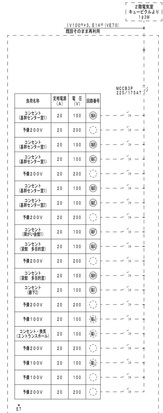
既設電灯盤 (端末機用分電盤) 参考結線図 (改修後)
