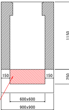
5号既設集水樹
