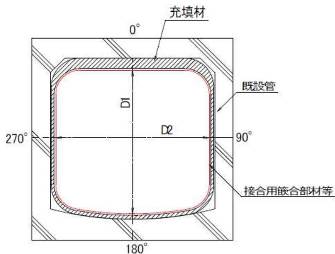
図 5.1.1 仕上り内径の測定位置(複合管)
