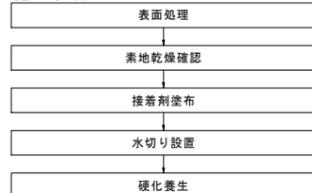
注1) 水切りと床版の接着性、施工性、水切り機能を確保するため、床版の端から50mm程度の余裕しるを確保すること。
