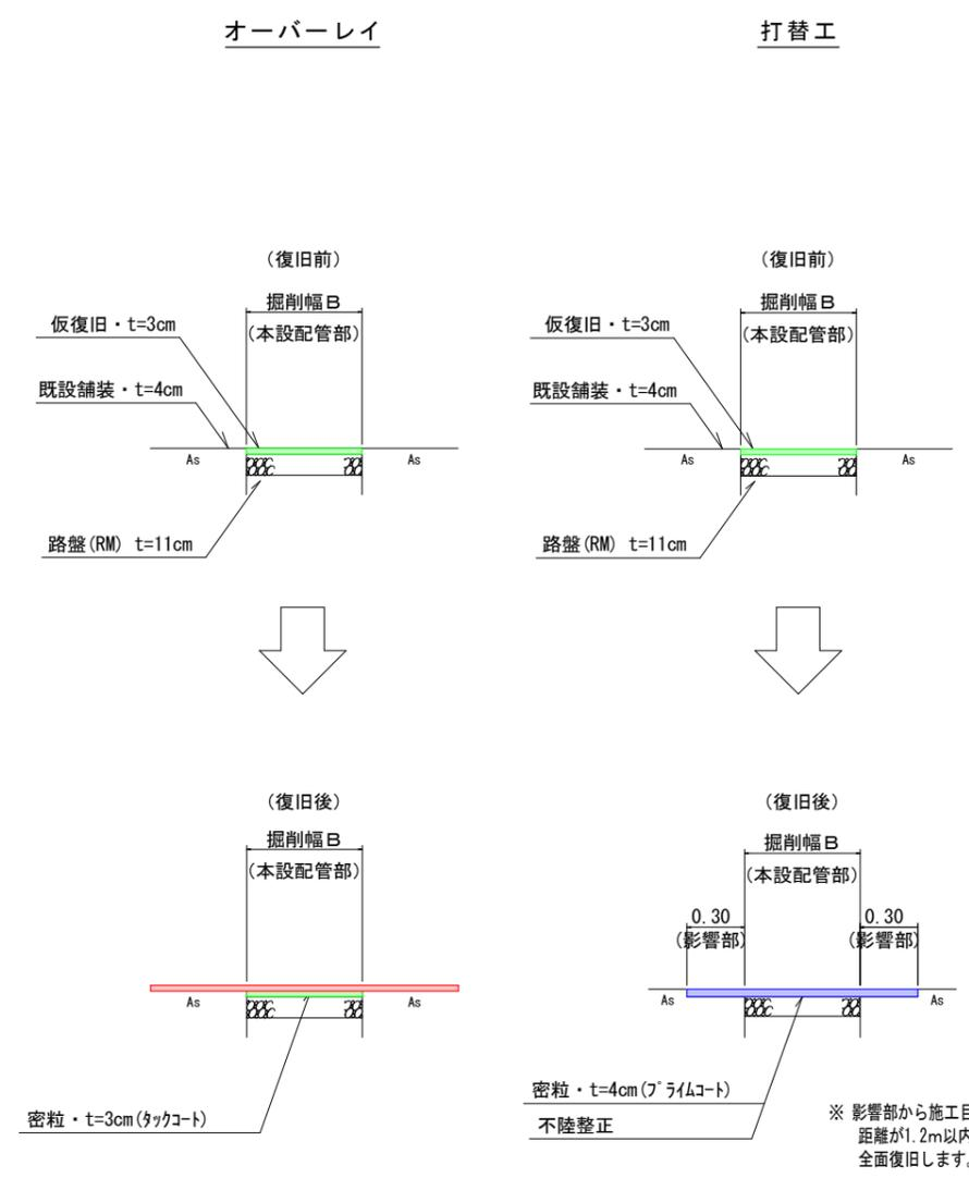
※ 影響部から施工目地までの距離が1.2m以内の場合は全面復旧します。
