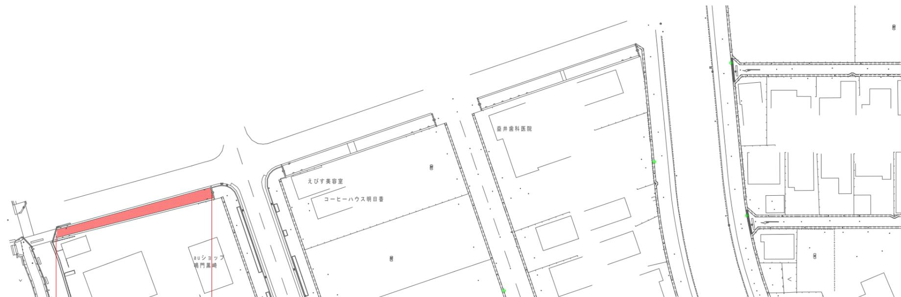
土砂撤去延長 L=50.0m, 堆積厚 t=10cm, 土砂撤去量 V=10m<sup>3</sup>
