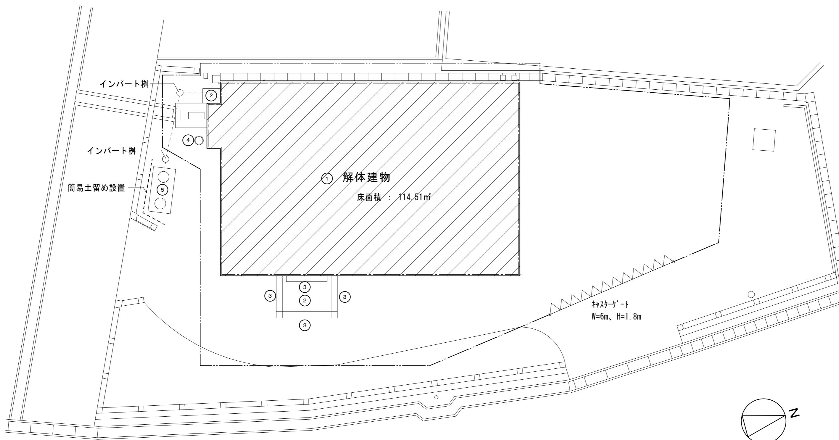
——— くさび緊結式足場 防音シート  $H=3.6\text{ m}$  設置位置を示す。
