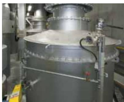
■流動床式ガス化炉
